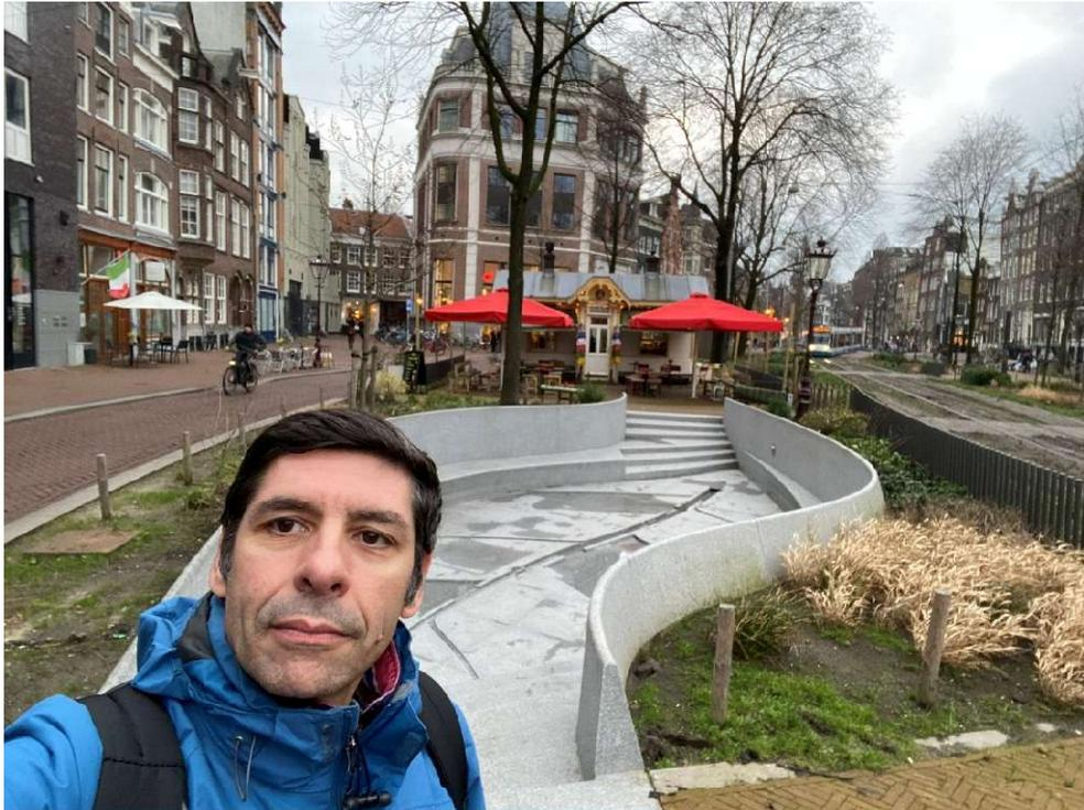
Figura 07 – una struttura multifunzionale depressa realizzata nel centro di Amsterdam collegata alla rete idraulica di deflusso meteorico
