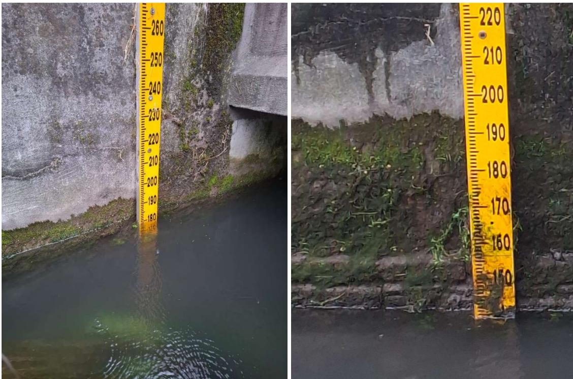
*Figura 3 – La riduzione del livello idrometrico sul fiume Melma prima e dopo il taglio delle piante acquatiche in data 25 Luglio 2025*
