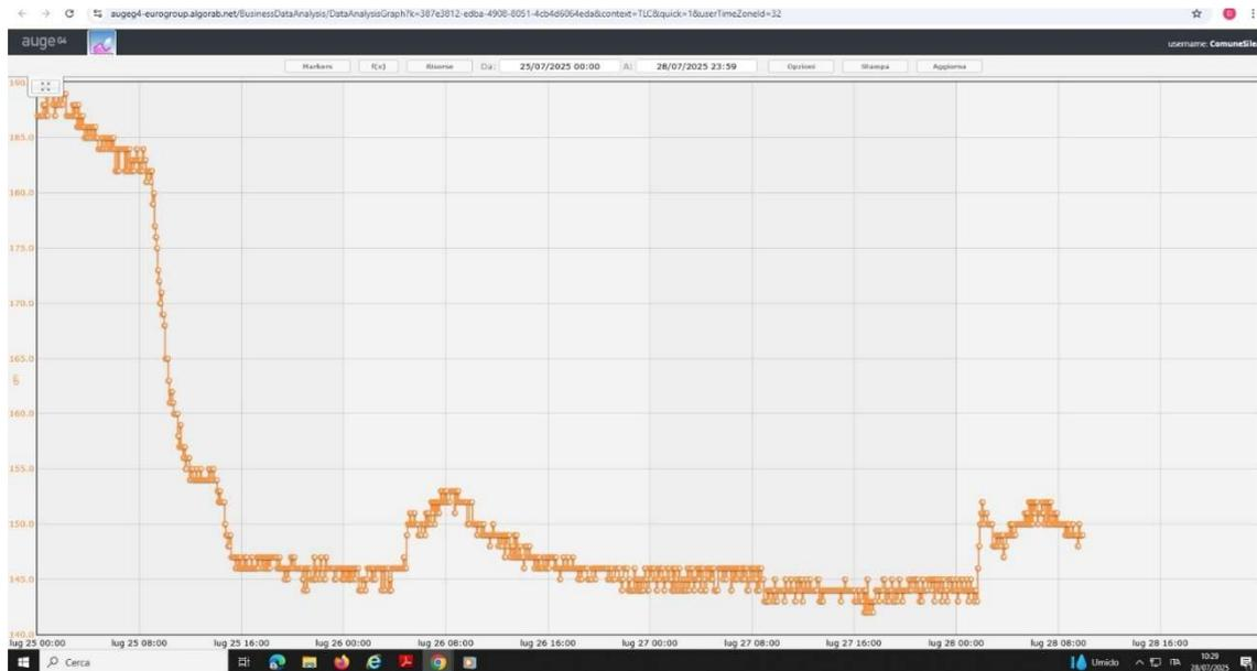
*Figura 2 – Livello idrometrico del fiume Melma registrato a monte del ponte di via Roma il 25 Luglio 2025 a seguito del taglio delle piante acquatiche nel tratto dal ponte di via Roma alla proprietà ex Chiari e Forti*
